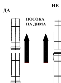
Фигура 7. Начин за монтаж на димните тръби
