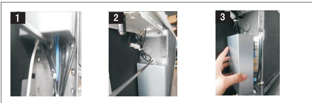
3.Разкачете конектора на мотора, конектора на захранването, конектора за 3-пътния вентил, конектора за сензора за входящ въздух и конектора за сензора за входяща вода.
