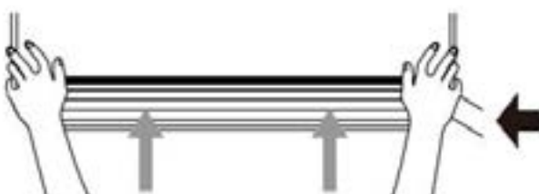
Korak 8: Kačenje unutrašnje jedinice
