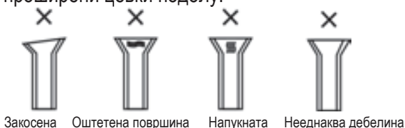
Закосена Оштетена површина Напукната Неоднаква дебелина
