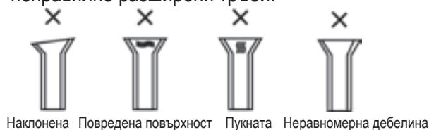
Наклонена Повредена повърхност Пукната Неравномерна дебелина
