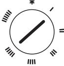
smjeru kazaljke na satu na najveću vrijednost, kada se postigne željena od Vas sobna temperatura, termoregulator bi trebao se okretati polako u suprotnom smjeru kazaljke na satu dok čujete termoregulator da „klikne“. Zatim će jedinica održavati temperaturu zraka u prostoriji do postavljenе razine uključivanjem i isključivanjem automatski.
